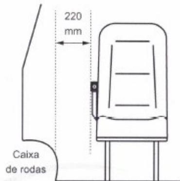
Figura 15 - Espaçamento entre poltrona e caixa de rodas
