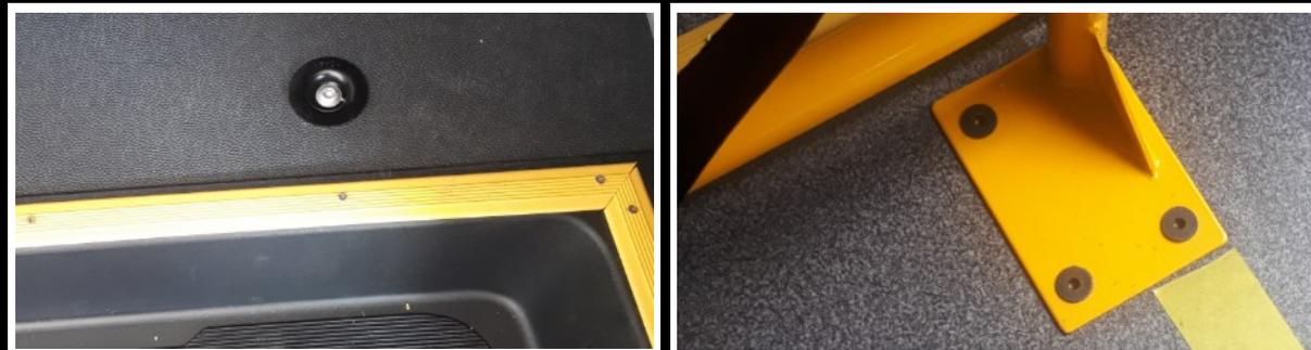
Perfis de sinalização e guarda corpo não ultrapassando a altura permitida para fixação. Na área de circulação o parafuso de fixação do piso está dentro do furo (embutido).
