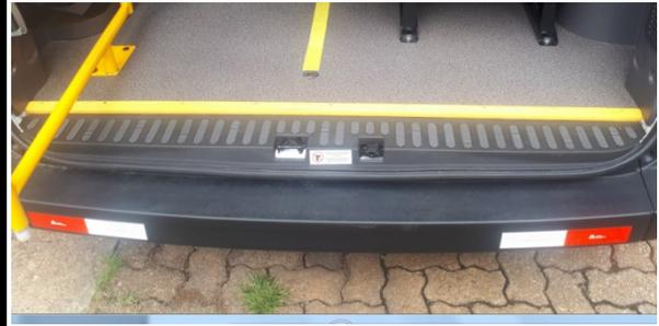
Faixas refletivas instaladas na lateral e para-choque, conforme Resolução Contran
