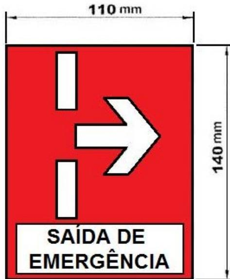
Figura 3 – Modelo de adesivo indicativo da saída de emergência
