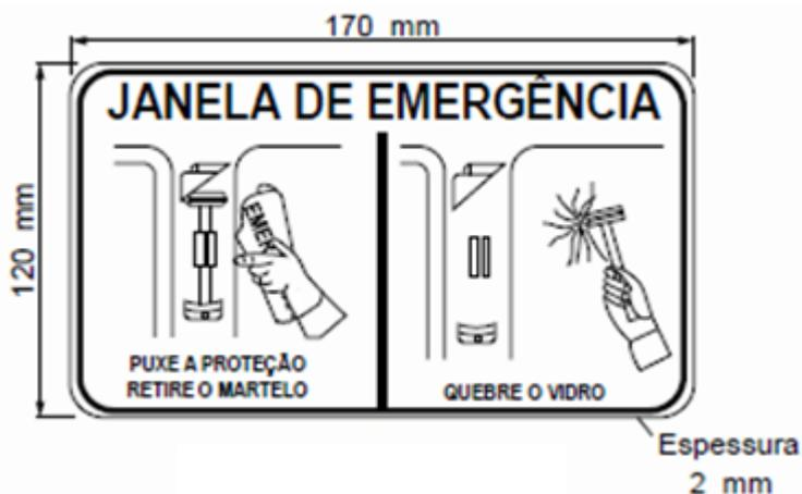
Figura 5 – Modelo do adesivo para instrução de utilização do dispositivo de destruição
