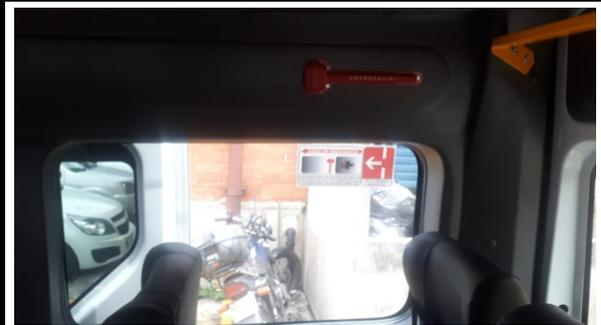
Janela de emergência sinalizada e com instruções de uso do dispositivo de destruição (martelinho com capa) instalado próximo à janela de emergência
